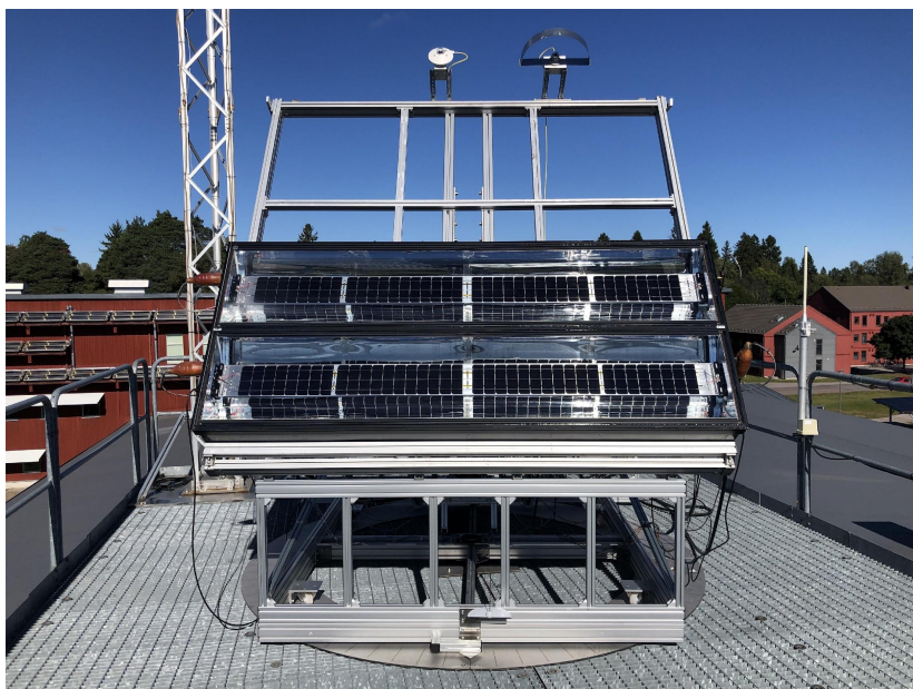
Bild från prototyp av den nya koncentrerande hybrid-solfångare i en specialbyggd testrigg vid Högsolan i Gävle.
